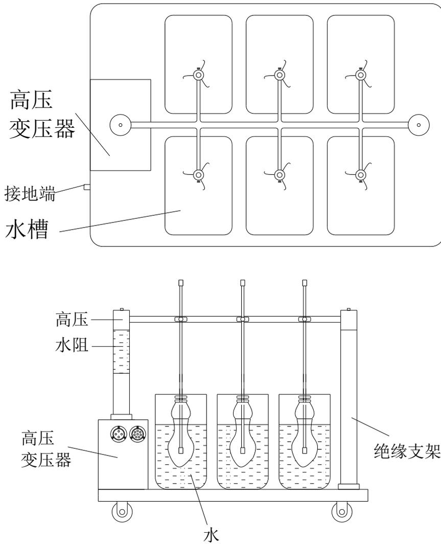
图 3-2 绝缘靴（手套）试验台
