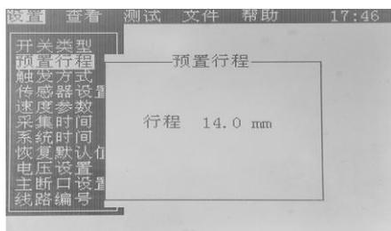
(3)、**触发方式设置**：按**确认键**进入，根据需要选择触发方式，选择好后按确认键保存。
