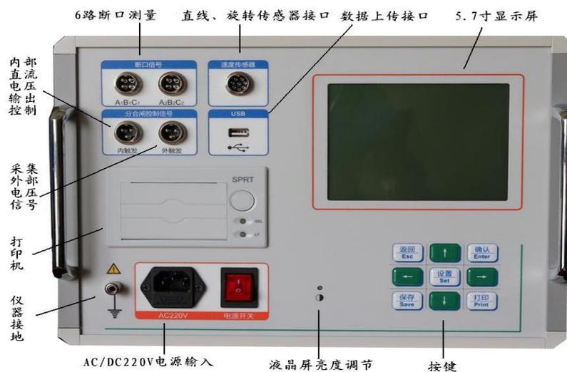
**断口信号**：接各相断口的动、静触头
