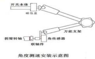
开关及六氟化硫安装示意图，这种安装方式主要是针对户外真空开关，安装在合指式针处，先把分合指式针卸掉，再把传感器连接头拧上去即可。
