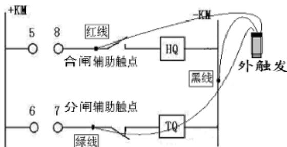
4.4 手动触发方式不需要接控制线。先在时间设置菜单中，把测试时间延长到 3 秒钟，接着在特性测试菜单中进行测量，然后快速进行手动分或合闸，即可采到信号，此动作要在 3 秒钟内完成，超过则不显示数据。
