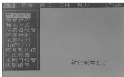
(1)、 **开关类型设置：**按**确认键**进入，按“↑”或“↓”移动光标，再按**确认键**确定，如下图：
