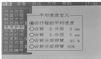
(6)、采集时间设置：按**确认键**进入，默认时间为 0.5 秒，如选择是**内触发**方式，此项不要更改，采集时间是指电压输入的时长，如果设置时间过长，容易造成开关线圈损坏。如果选择**手动触发**方式，这时采集时间就是指断口信号时间采集长度，一般为 3 秒钟即可，按“↑”或“↓”键来设置时间长短。
