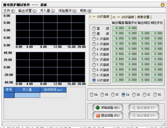
在中部的输入框中设置"输出幅值"、"幅值步长"、"输出相位"、"相位步长",
