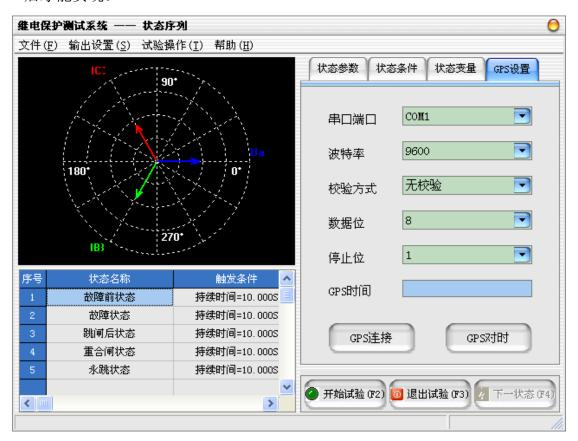
当选择"GPS触发"时,点击"开始试验",测试仪并不会立即输出电压、电流,只有当下一分钟的0秒到时,测试仪才会开始输出下一状态的电压、电流,在该状态设置的"zui长状态时间"到后,将进入下一状态。
