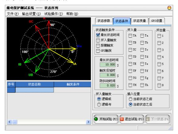
在"状态条件"属性页中设置当前状态的触发条件。zui长状态时间和开入量触发可同时选择作为一种触发条件。两者为"或"的关系,只要其中一个条件满足,试验将进入到下一状态。在故障前状态zui长状态时间的设定时,一般要大于保护装置的整组复归或重合闸的充电时间。当满足所设置的触发条件后,试验自动进入到下一状态。触发条件满足后,测试仪的对该状态的输出要在触发后延时结束后(设置了触发后延时时间),方进入到下一试验状态。在"状态条件"属性页中还可以设置开入量、开出量和状态插入的位置。
